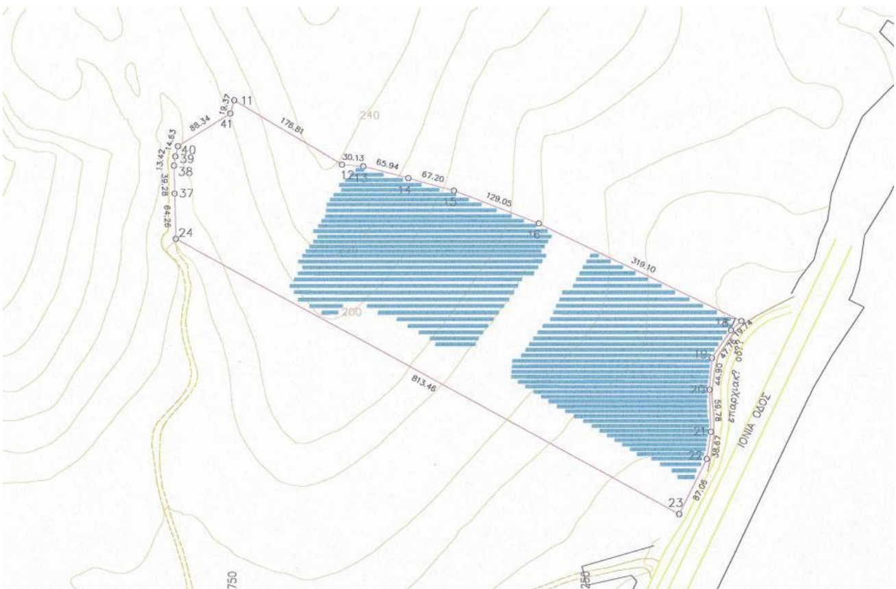
Εικόνα 3-4. Χωροθέτηση Φ/Β πλαίσίων
