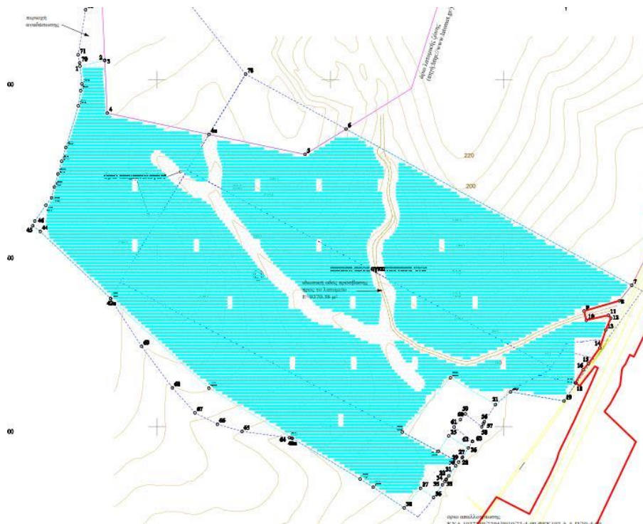
Εικόνα 6.4.: Γήπεδο εγκατάστασης του Φ/Β σταθμού, προβλεπόμενη χωροθέτηση των Φ/Β πλαισίων
